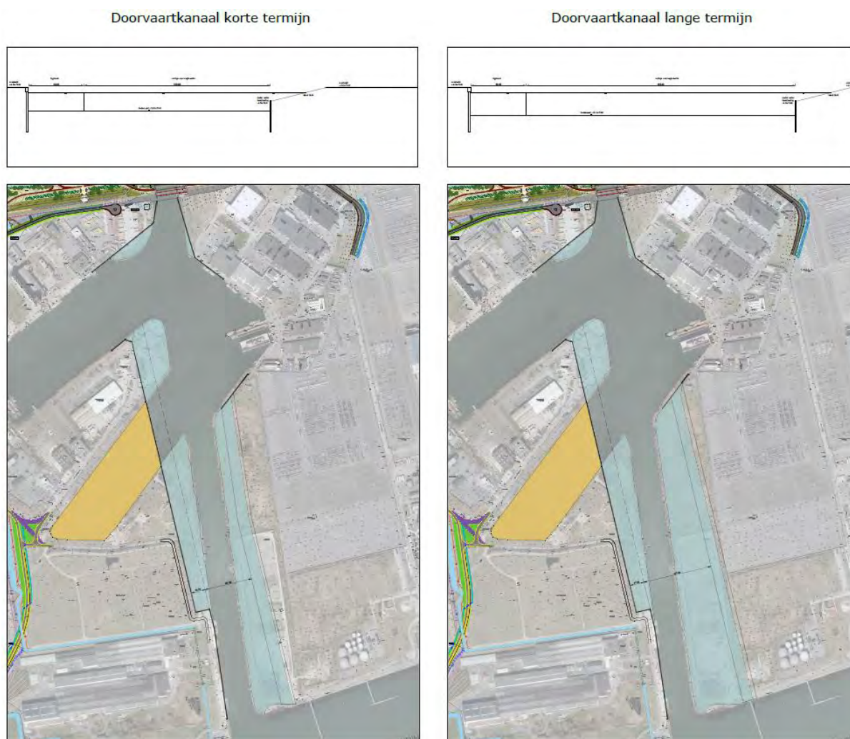
Figuur 2-12 : Verbreding en verdieping Doovaartkanaal volgens eerste fase (links) en een latere fase (vermoedelijk 2045-2048) (rechts)
