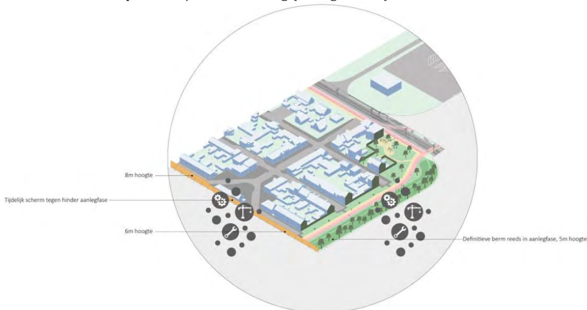
Figuur 2-5: Visualisatie tijdelijke schermen Veerbootstraat en Venetiëstraat (oranje), permanente berm K. Fryattstraat (groen) met fiets- en wandelpad (geel/roze lijn) en buurtparkje
